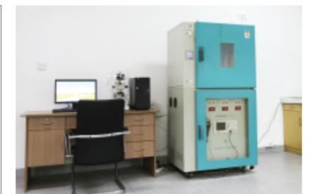
模拟EV车高频电晕老化试验仪器
